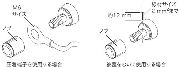
図 3-5 出力端子への接続
